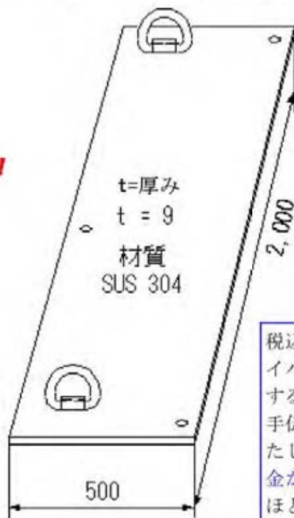
取付け金具詳細図
